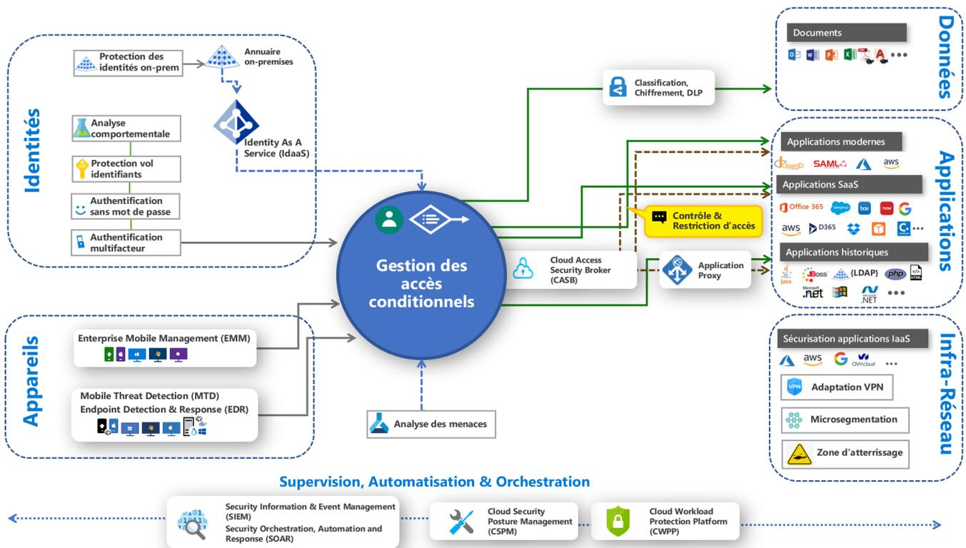
Le schéma ci-dessus montre des exemples de briques techniques pouvant être mises en œuvre dans le cadre d'une implémentation Zero Trust. Le lecteur doit garder à l'esprit qu'il n'existe pas de solutions universelles pour les domaines évoqués dans la suite de cette section et que chacun devra identifier – au moyen d'une étude de transformation Zero Trust –, celles qui sont réellement adaptées à son contexte métier et à son environnement technique.
