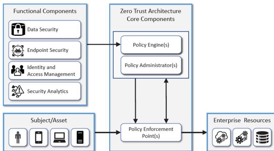
On retrouve dans la colonne centrale le [moteur du contrôle d'accès dynamique](#). Il régit les accès entre les sujets ou actifs (utilisateurs, appareils, objets connectés, etc.) et les ressources de l'entreprise. Les autres blocs fonctionnels concernent la sécurité des données, la sécurité des appareils (à partir desquels les identités demandent l'accès), la gestion des identités et l'analyse des données de sécurité.
